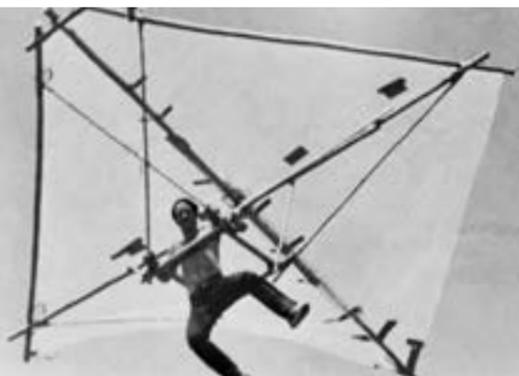
Moyes und Bill Bennett erkannten und nutzten die Vorteile des Steuerbügels und begannen mit der Produktion eigener Deltas nach dem neuen Prinzip. Der Steuerbügel, bestehend aus zwei Seitenrohren und einem Basisrohr, oft nur als «Basis» bezeichnet, erhielt übrigens im deutschsprachigen Raum die Bezeichnung «Trapez». Ergänzt wurde die Delta-Konstruktion durch einen Turm, sowie eine Ober- und Unterverspannung aus Stahldrähten.
