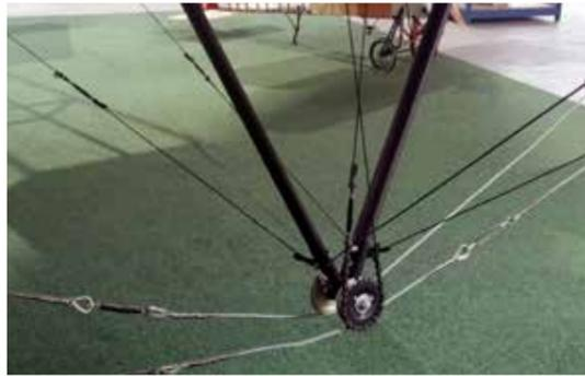
Zahnrad und Umlenkrolle zur Betätigung der Verwindung (Querlage)
