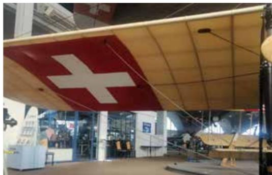
Die Konstruktionswerkstätte K+W Thun rüstete die Eigenkonstruktionen DH-3 und DH-5 mit Seilzügen und entsprechenden Umlenkrollen aus. Der Pilot musste alle aerodynamischen Kräfte an den Steuerflächen selbst überwinden und ausgleichen.
