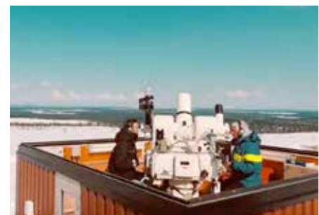
Kinotheodolit zur Verfolgung der Lenkwaffen und des Ziels
